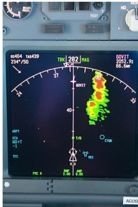
Slika 11 Meteorološki radarski sustav u zrakoplovu Boeing 737 [18]
