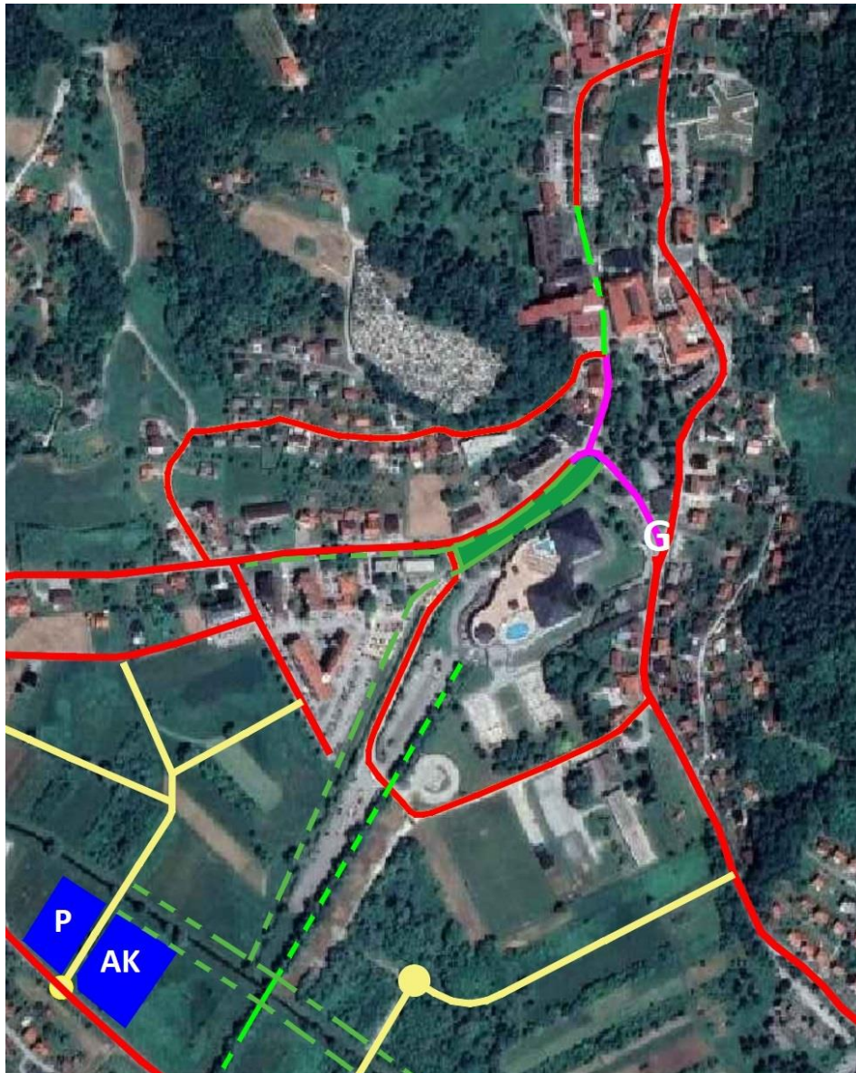
Slika 52. Prikaz postojećih (crveno) i planiranih (žuto) cesta, pješačkih površina (zeleno) te lokacija na kojima je predviđena gradnja autobusnog kolodvora (AK) s parkiralištem (P) te lokacija planirane podzemne garaže (G)
