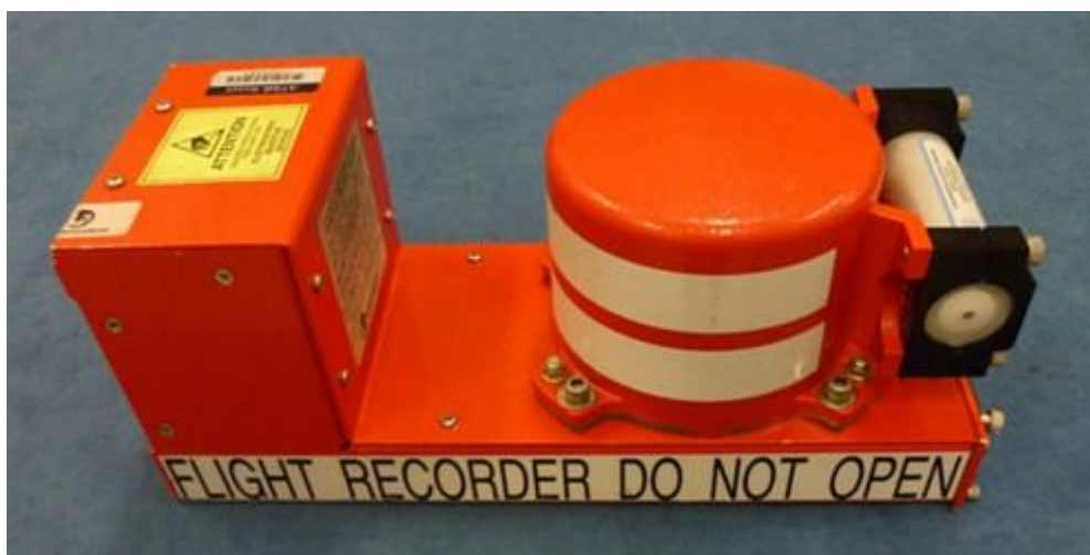
Slika 3. Uređaj za snimanje zvuka u kokpitu
