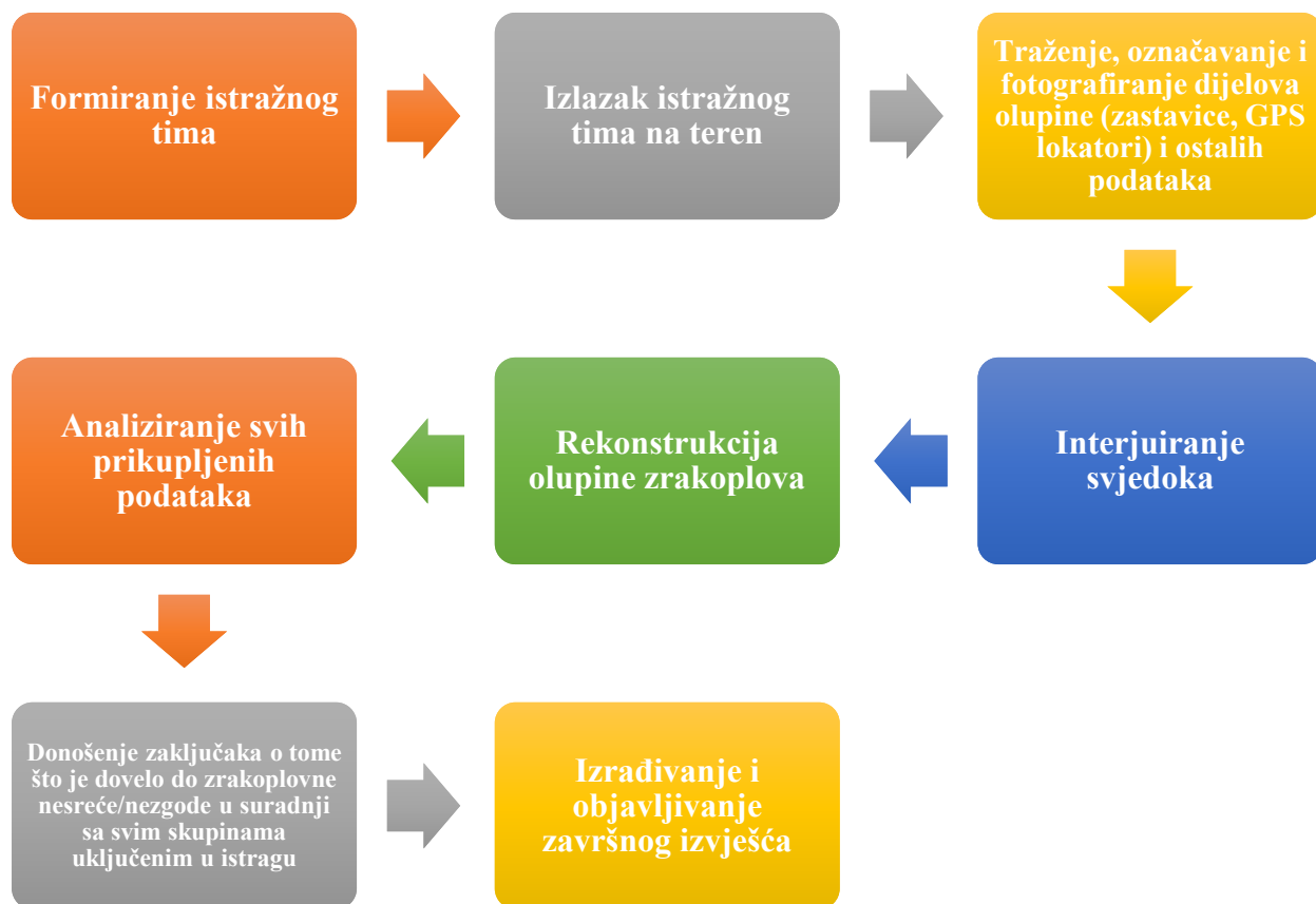
Slika 10. Pojednostavljeni prikaz provođenja istrage zrakoplovne nesreće ili nezgode
