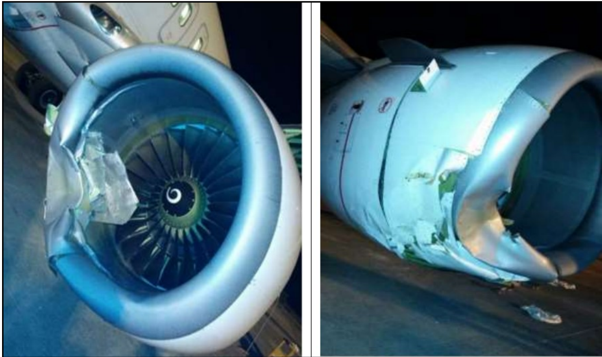
Slika 19. Oštećenje na lijevom motoru, [25]
