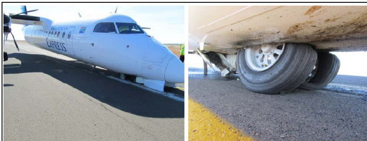
Slika 14. Šteta na zrakoplovu Bombardier DHC 8-300 kao posljedica sudara s kapskim mravojedom, [21]
