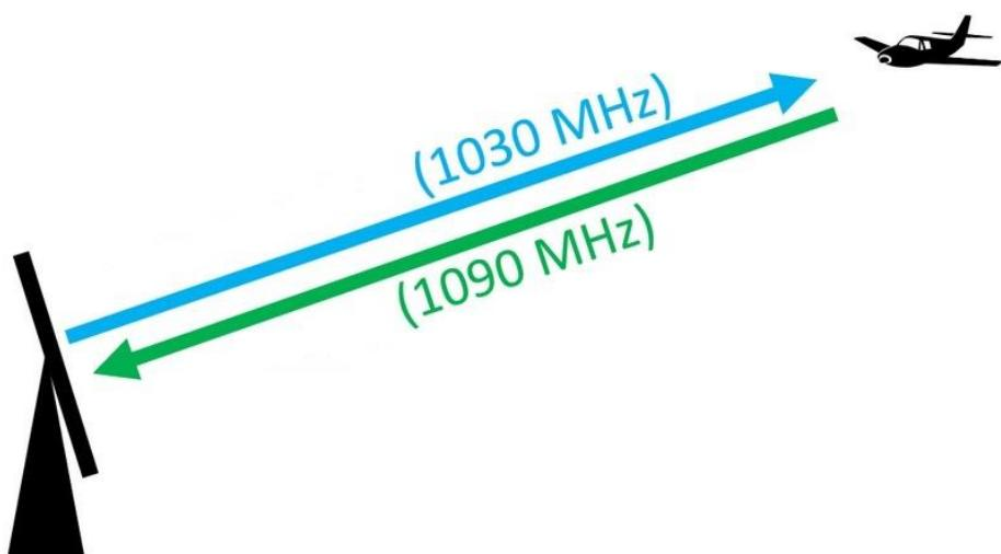
Slika 2. Princip rada Sekundarnog nadzornog radara, [22]
