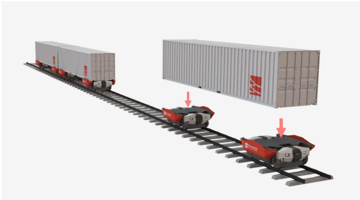
Slika 10. Ukcavanje kontejnera i spajanje u konvoj Parallel Systems vagona
