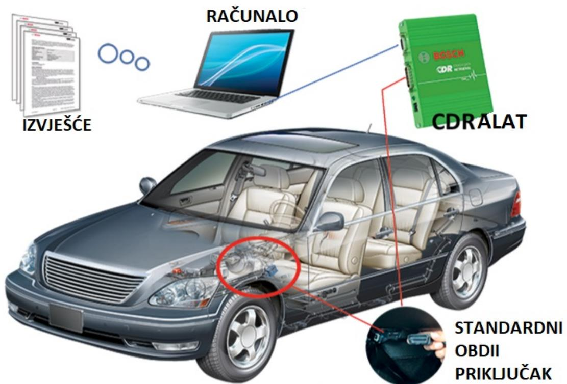
Slika 8. Shematski prikaz pozicije EDR uređaja
