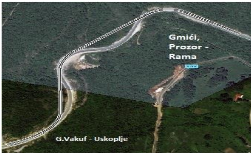
Slika 35. Idejno rješenje poboljšanja tlocrtnih elemenata dionice – Gmići
