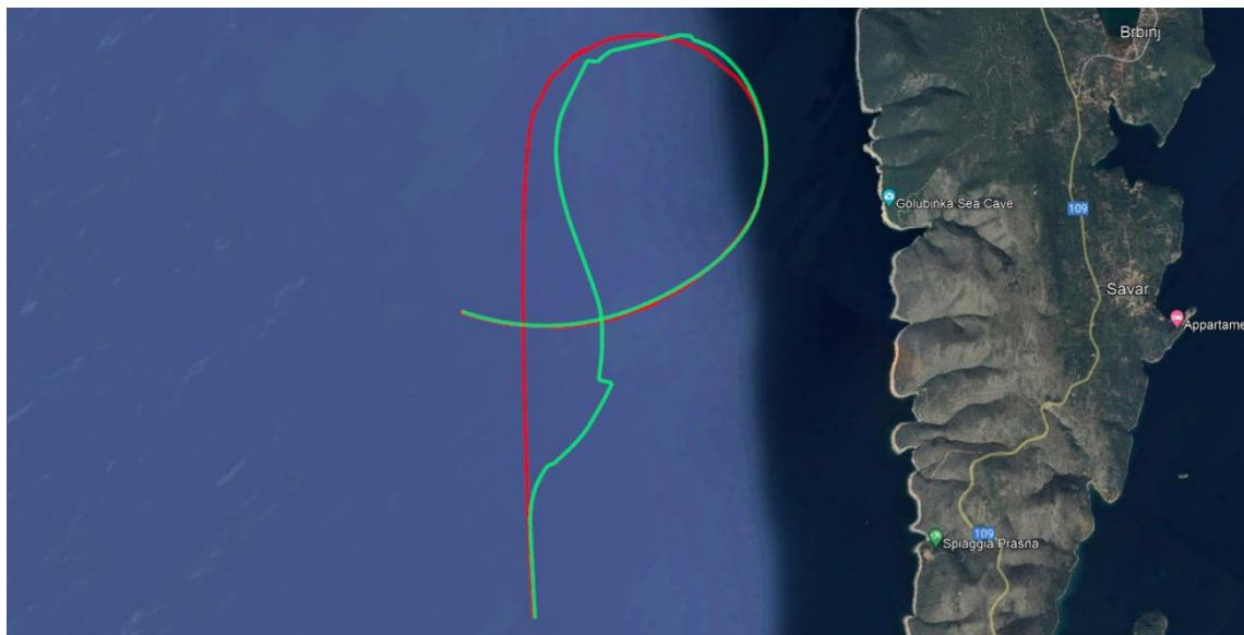
Slika 29. Putanje aviona dobivene GPS mjerjenjem
