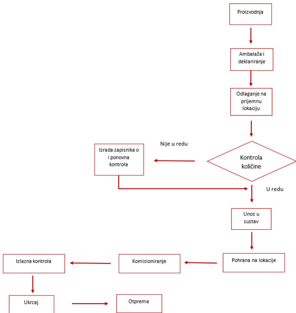
**Slika 23: Skladišni procesi pri manipulaciji proizvedenih proizvoda**
