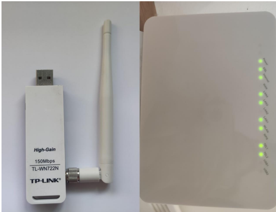
Slika 3. Usmjerivač i USB Wi-Fi adapter korišteni u istraživanju
