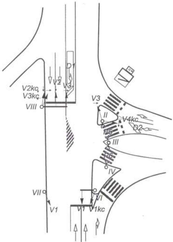
Slika 29. Raspored i oznake signala i detektora
