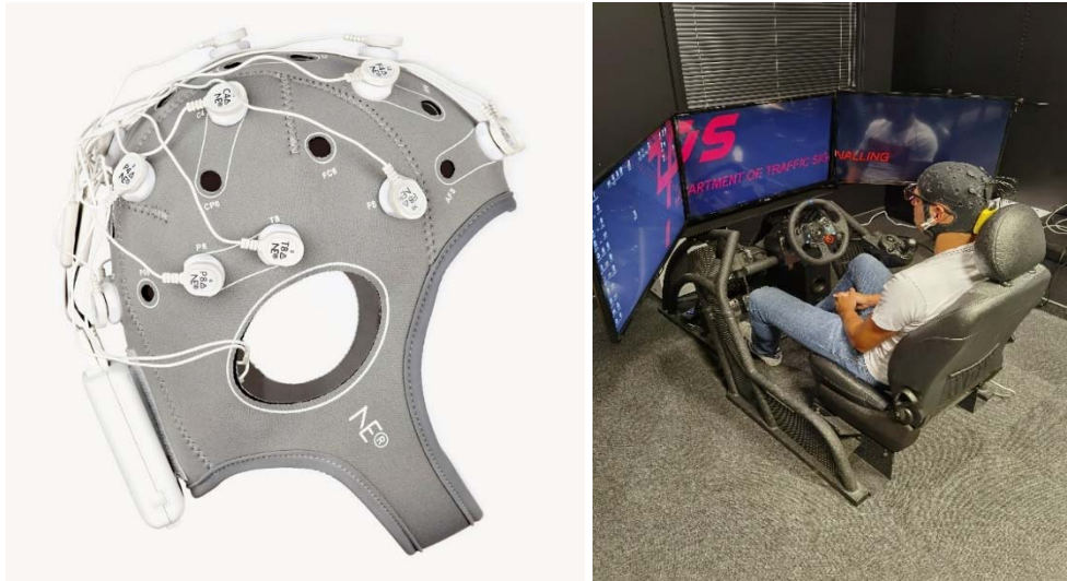
Slika 19. Neuroelectrics neoprenska kapa za postavu elektroda i glavne jezgre sustava
