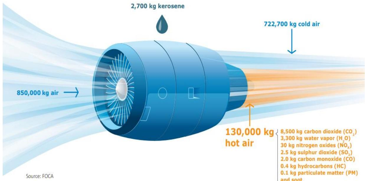
Slika 11. Emisije štetnih ispušnih plinova na mlaznom motoru, [19]
