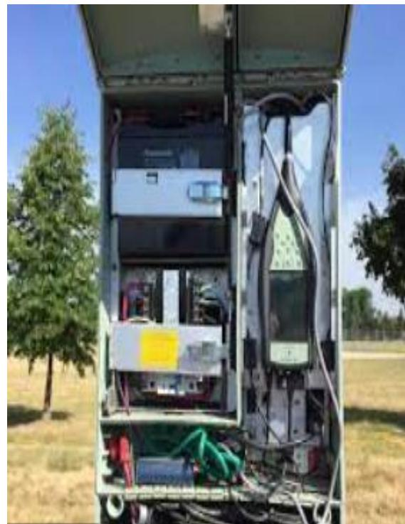
**Slika 6.** Unutarnji izgled vodootporne kutije za procesiranje podataka o buci sa svim njezinim dijelovima, [12]
