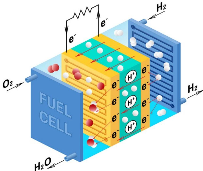
*Slika 6. Izgled i princip rada gorive vodikove ćelije*
