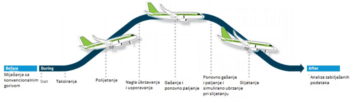
Slika 13. Faze testiranja zrakoplova u letu
