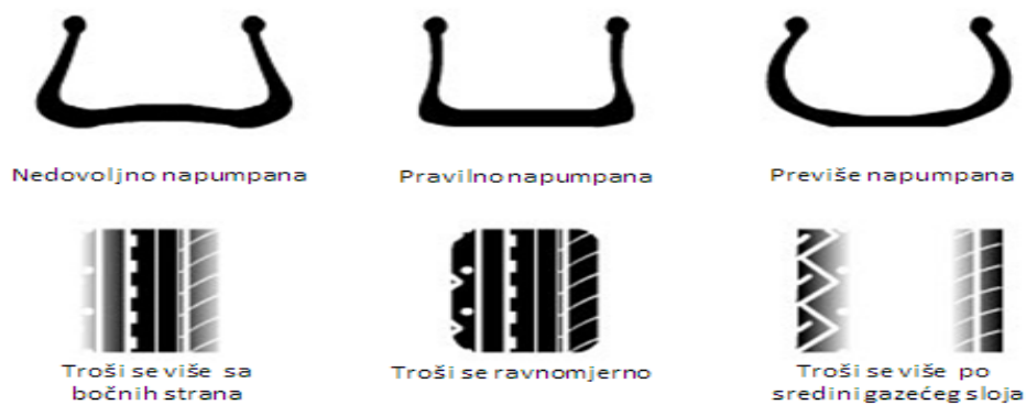
Slika 4.3. Prianjanje pneumatika kod različitog tlaka zraka
