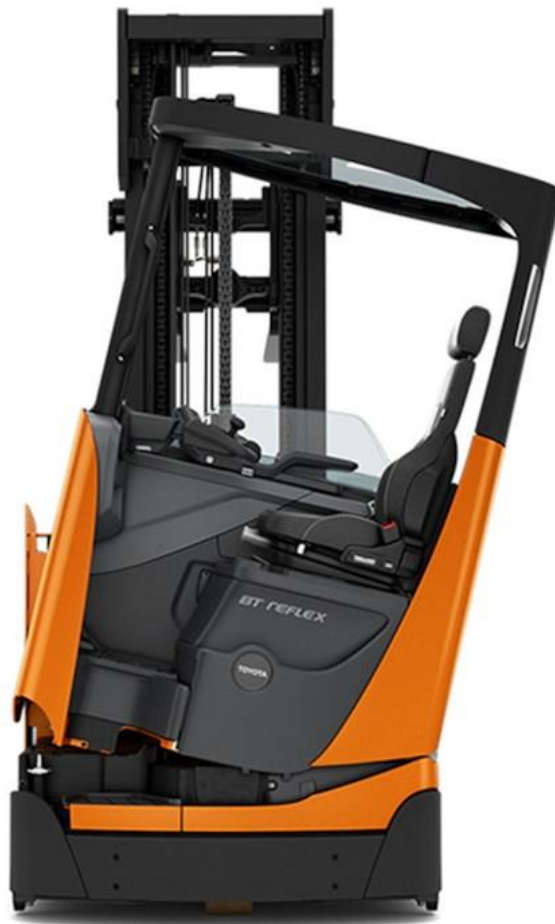
Slika 5. Toyota viličar s nagibom cijele kabine
