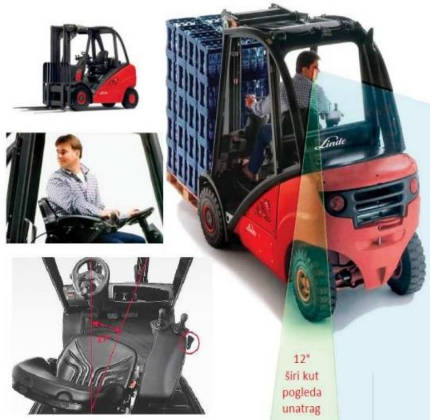
Slika 4. Linde viličar sa zaokretnim sjedalom
