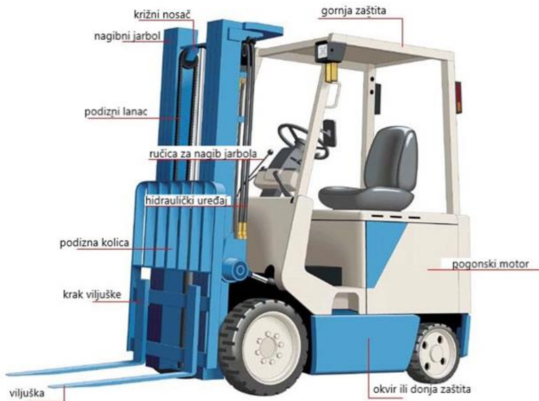
Slika 1. Prikaz i karakteristike viličara
