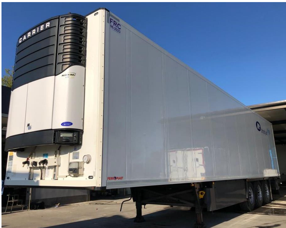
Slika 21. Poluprikolica sa mehaničkim rashladnim uređajem Carrier
