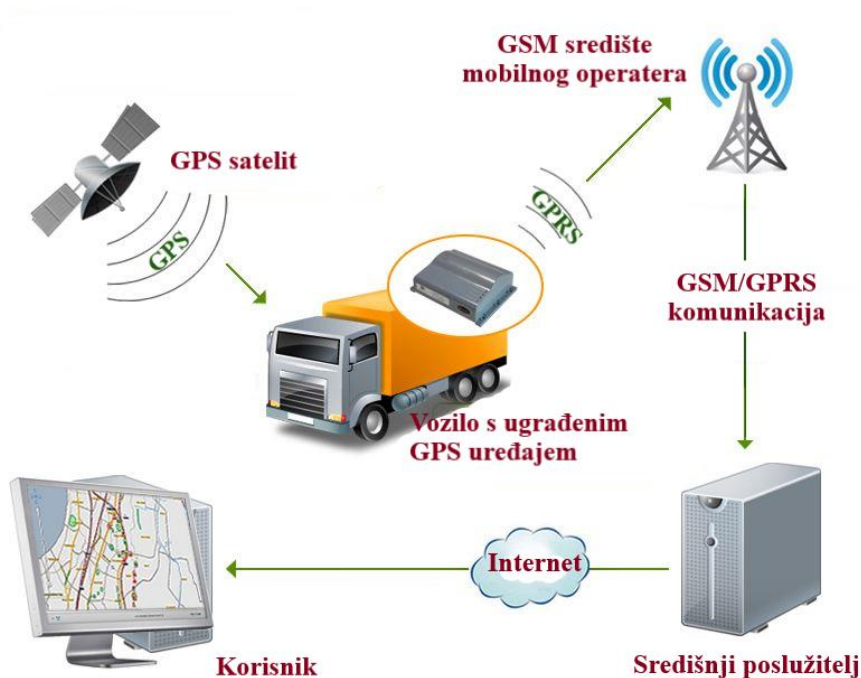
Slika 2. Funkcioniranje sustava za upravljanje voznim parkom
