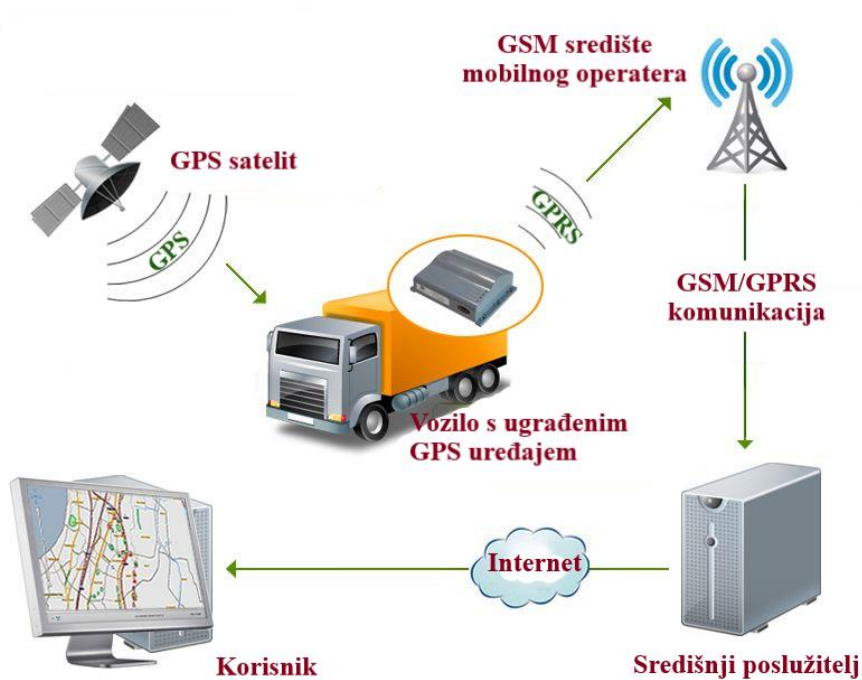
Slika 2. Funkcioniranje sustava za upravljanje voznim parkom
