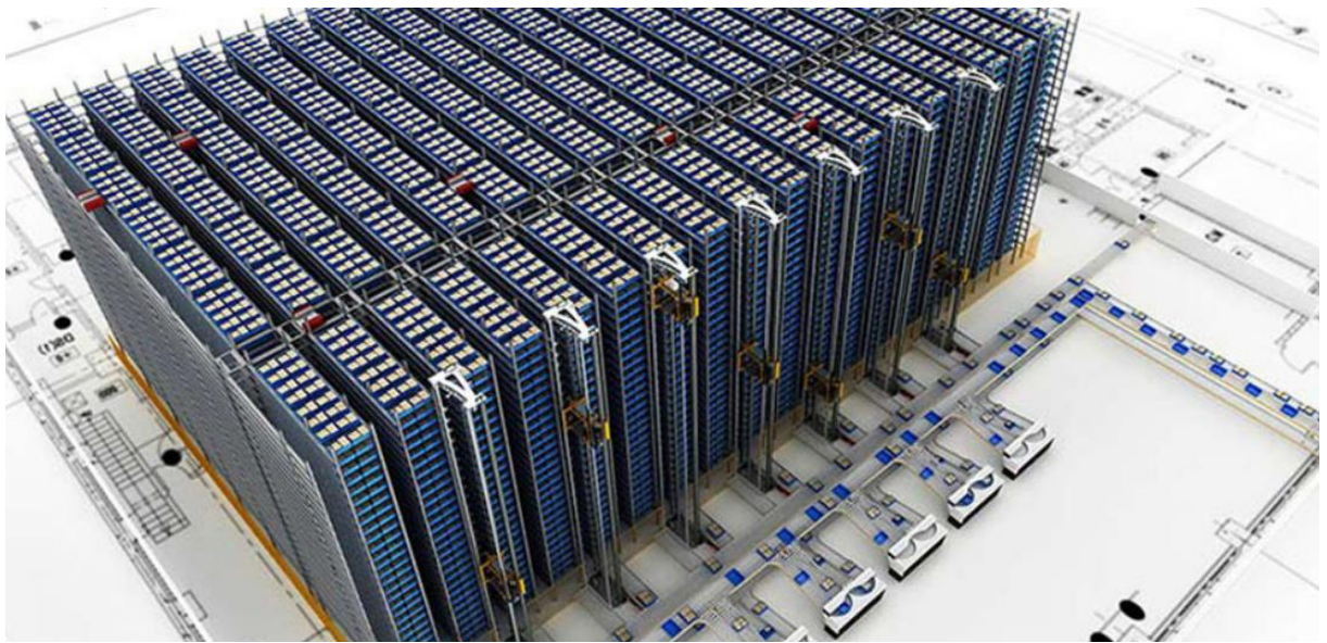
Slika 6.13 Mini load AS/RS sustav skladištenja
