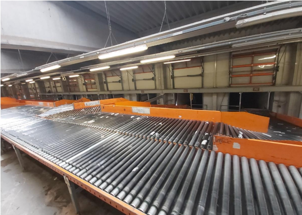
Slika 19. Prikaz sortirne rampe za četiri grada
