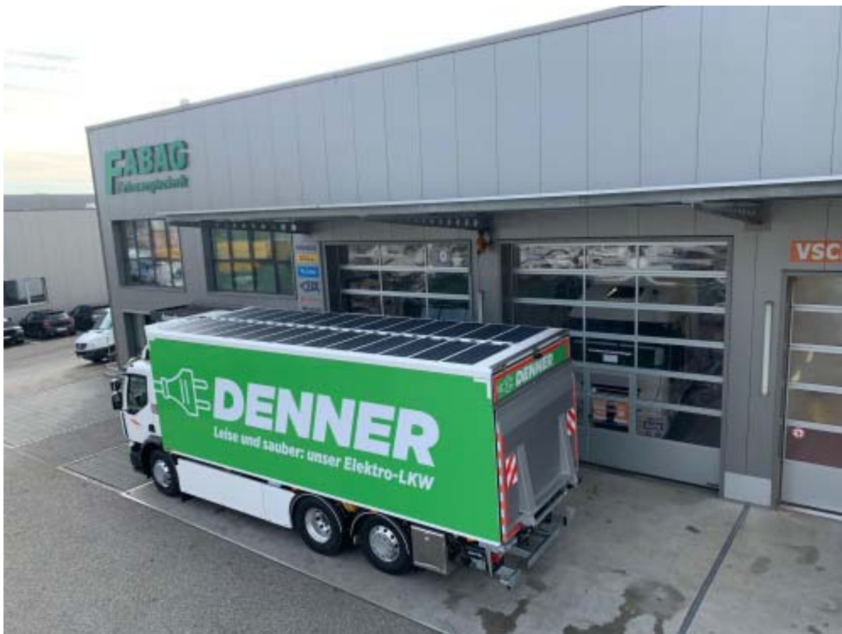
Slika 8: Električni kamion sa solarnim ćelijama
