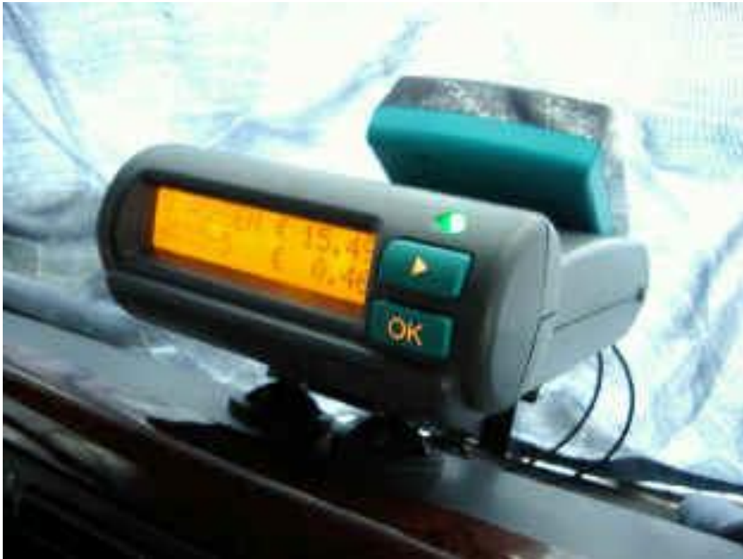
Slika 5: Uređaj za naplatu cestarine sa izmjenjivom karticom
