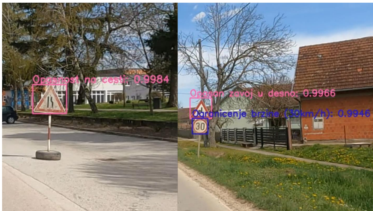
Slika 34: Prepoznavanje nečistih prometnih znakova
