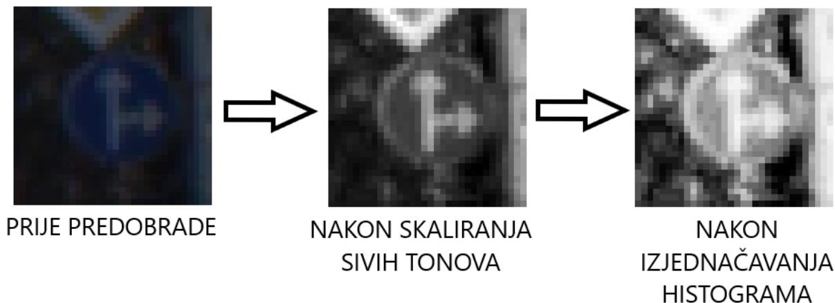
Slika 23: Prikaz procesa predobrade skupa za učenje
