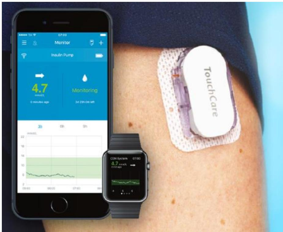
Slika 2. TouchCare Slim CGM sustav za kontinuirano mjerjenje glukoze u realnom vremenu
