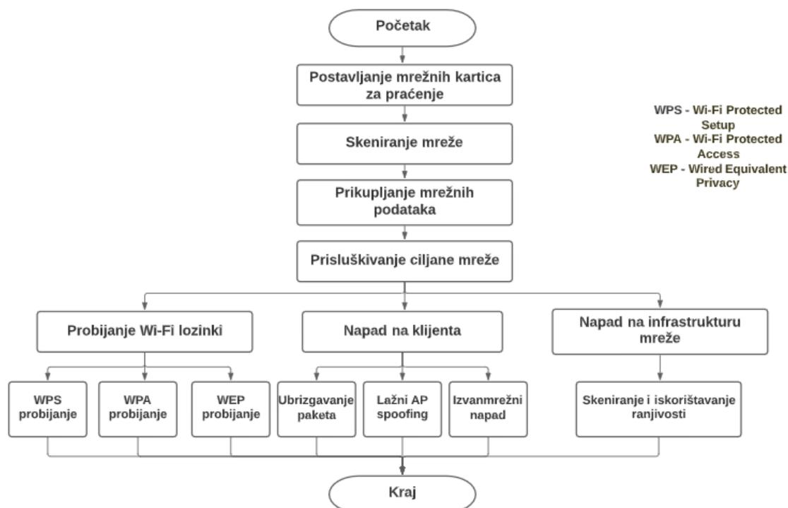
**Slika 2.** Proces izvođenja mrežnih penetracijskih testova
