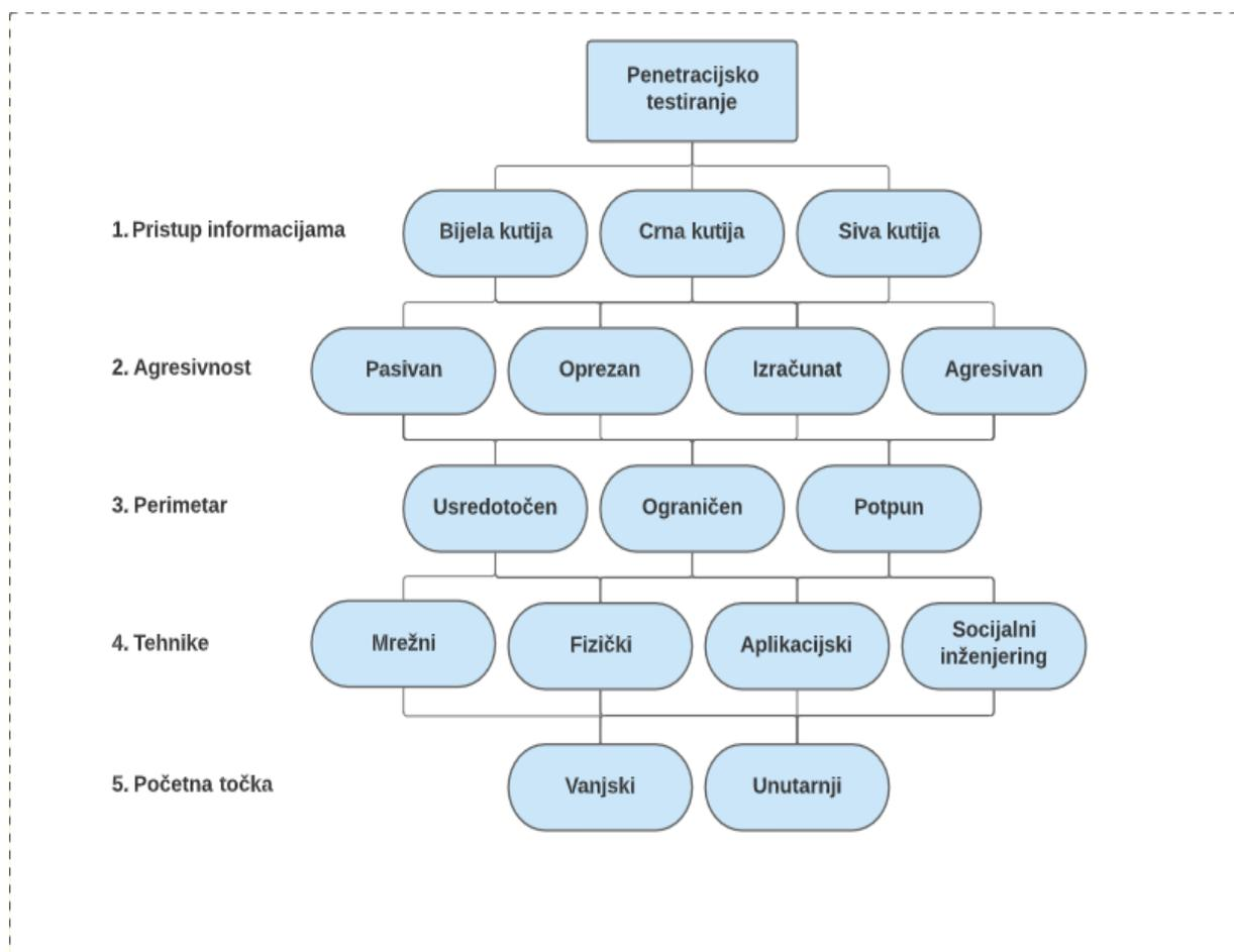
**Slika 1.** Klasifikacija penetracijskog testiranja
