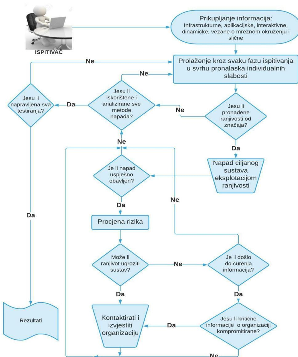
**Slika 6.** OWASP metodologija penetracijskog testiranja
