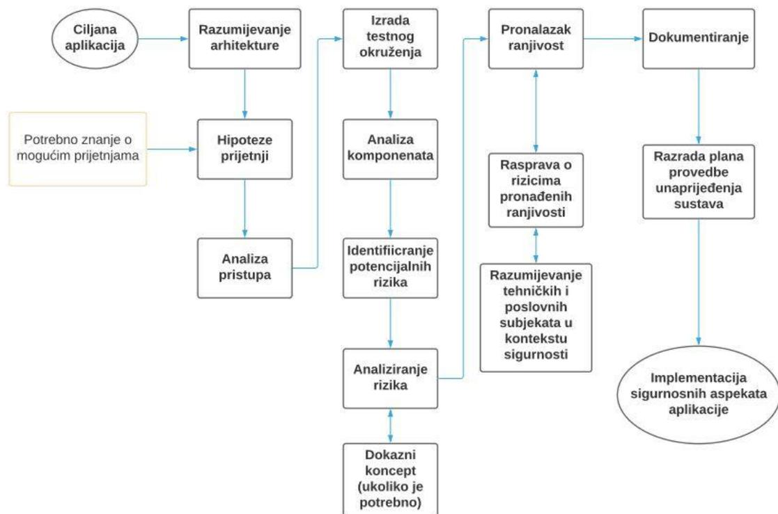
**Slika 3.** Provođenje penetracijskog testiranja aplikacija
