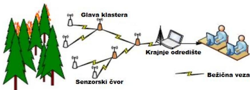
**Slika 11.** Primjena bežične senzorske mreže za otkrivanje požara
