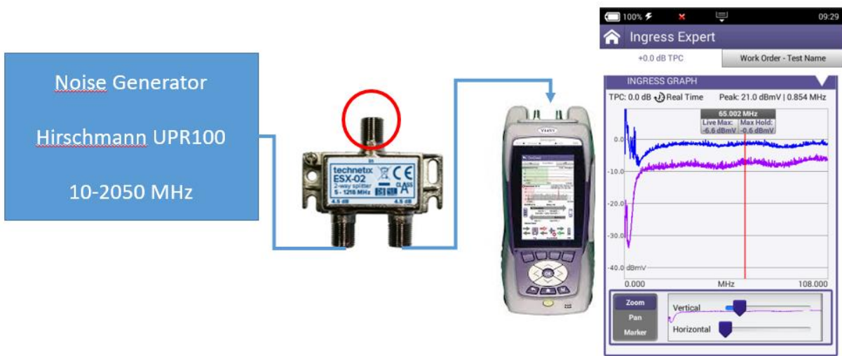
Slika 33. Imitacija greške u instalacijama
