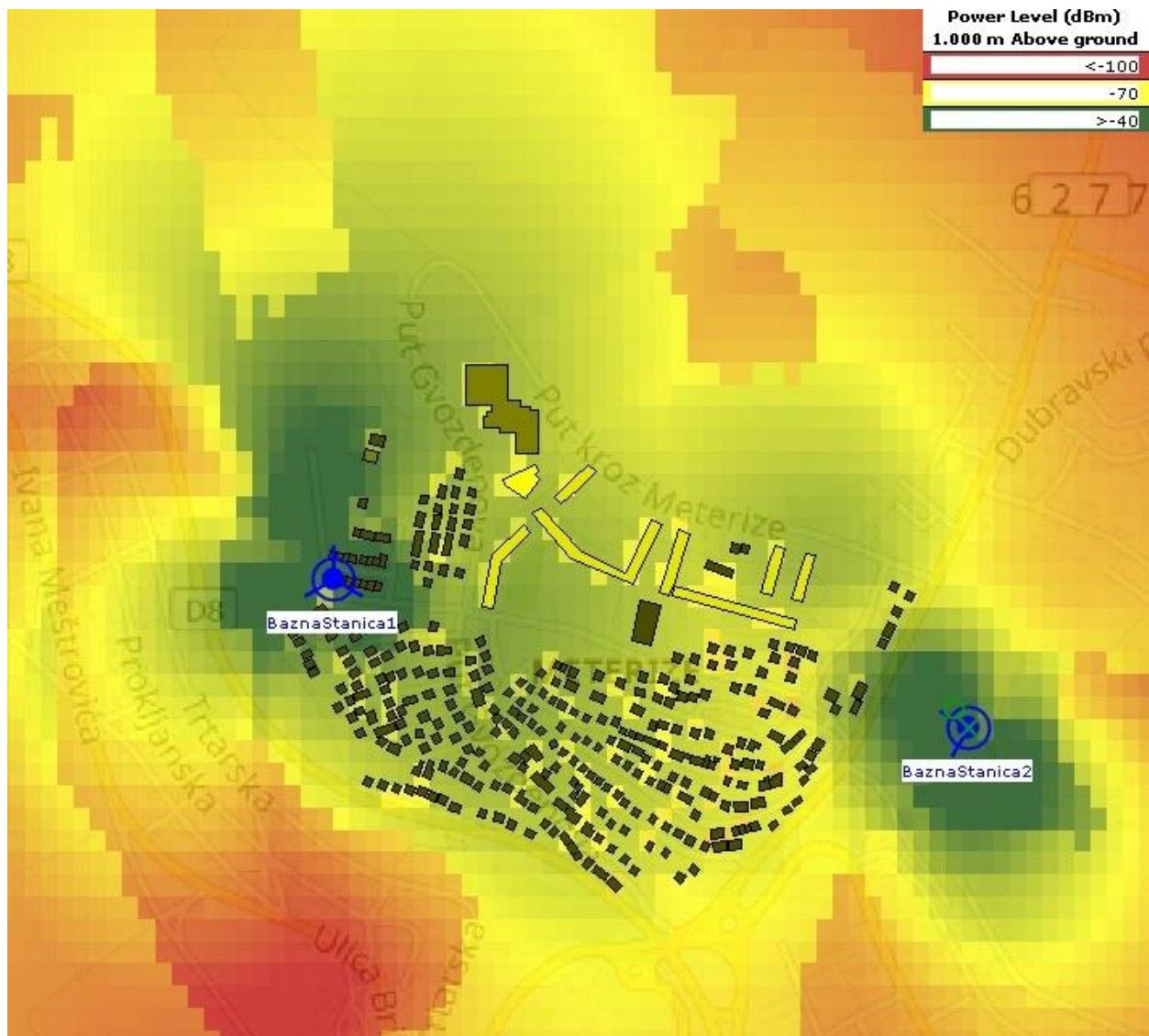
Slika 28. GSM razina snage unutar mikro ćelija
