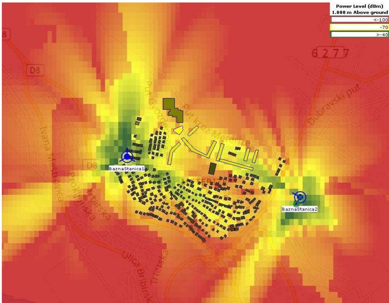
Slika 24. LTE razina snage unutar mikro ćelija
