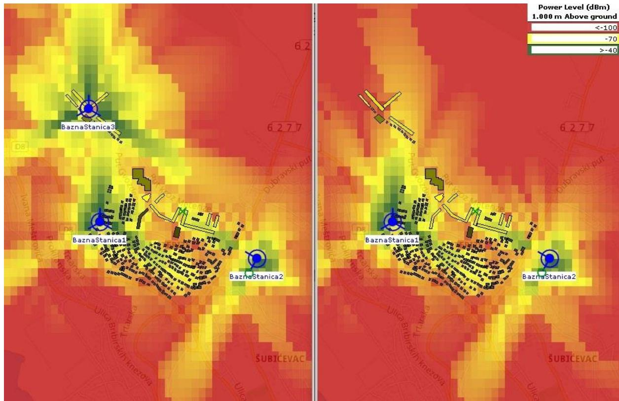
**Slika 32.** Usporedba LTE razine snage signalata uz dodavanje nove bazne stanice
