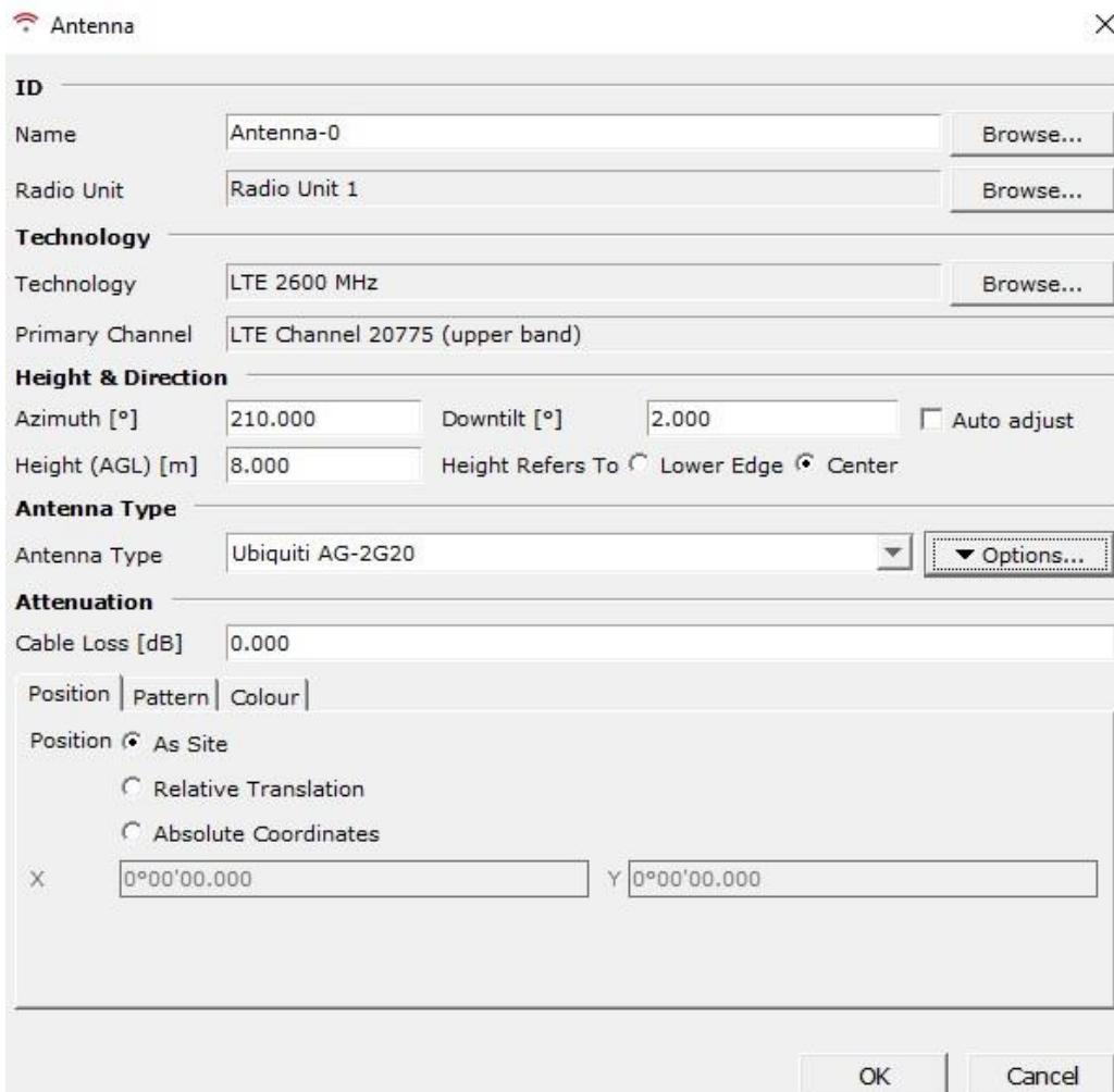
**Slika 19.** Definiranje vrste LTE antene, azimuta, visine i downtilt-a baznih stanica
