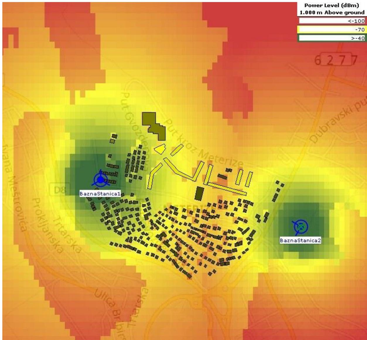
Slika 26. UMTS razina snage unutar mikro ćelija
