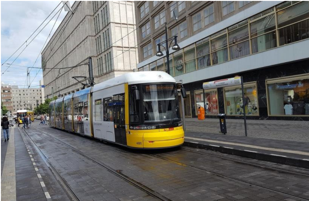
Slika 7: Tramvaj s niskom platformom
