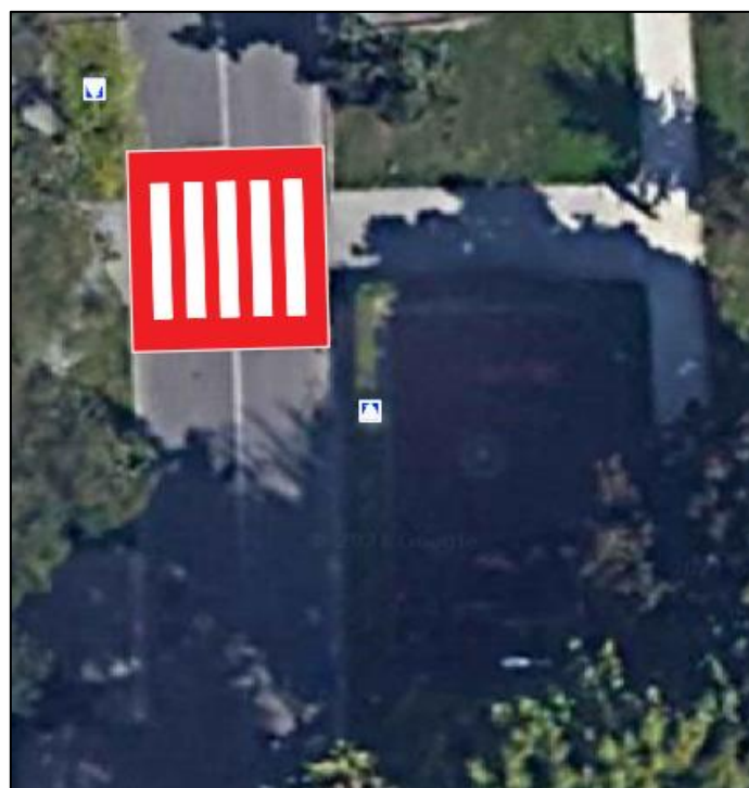
Slika 39 Prijedlog uzdignute plohe u Brozovoj ulici. Izvor: autor
