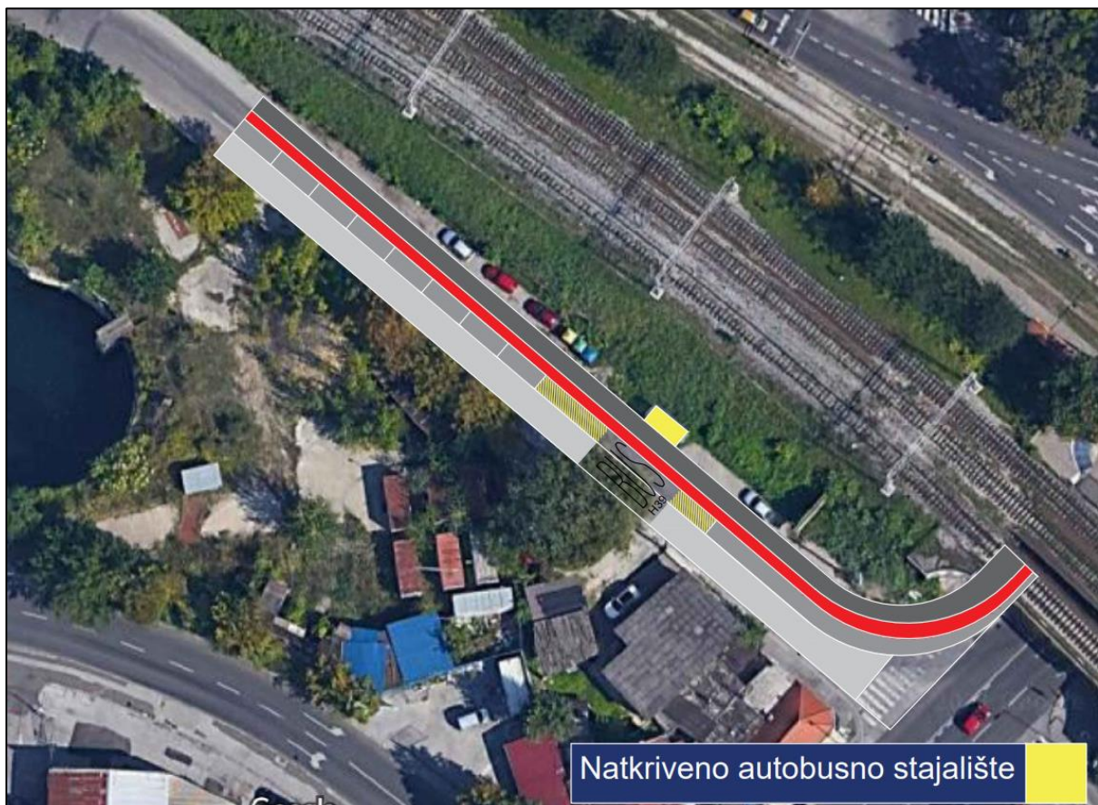
Slika 35 Prijedlog redizajna Magazinske ceste. Izvor: autor
