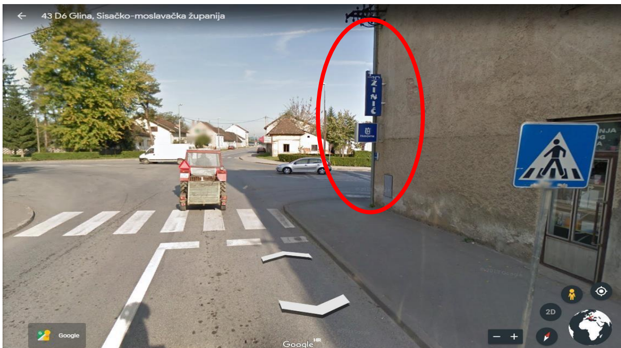
Slika 15. Prikaz infrastrukture koja smanjuje preglednost
