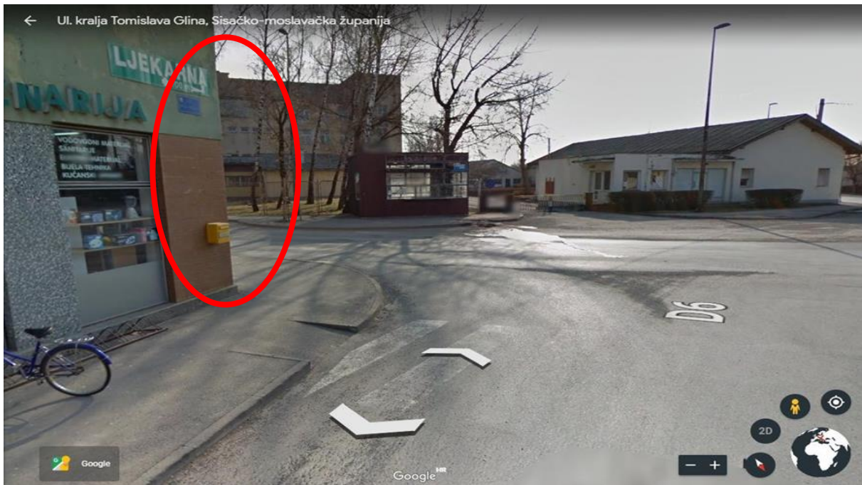
Slika 14. Prikaz loše horizontalne signalizacije i infrastrukture koja smanjuje preglednost
