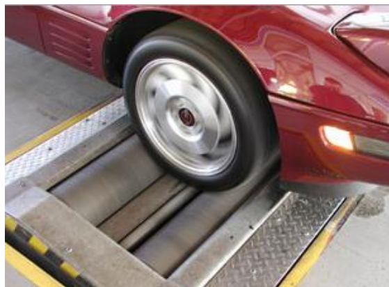
Slika 21. Ispitivanje kočnica na valjcima
