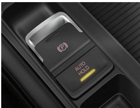
Slika 14. Električna parkirna kočnica
