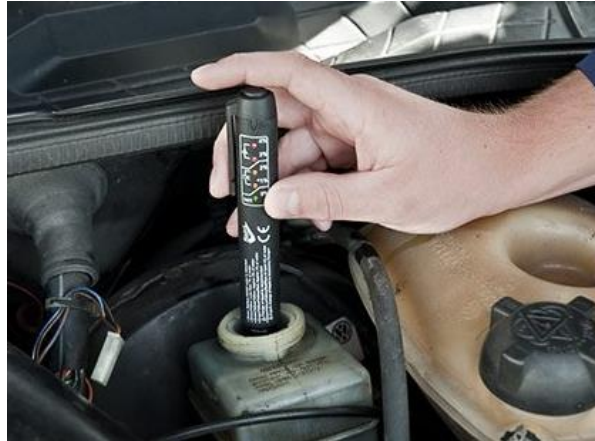
Slika 22. Ispitivanje kvalitete kočione tekućine
