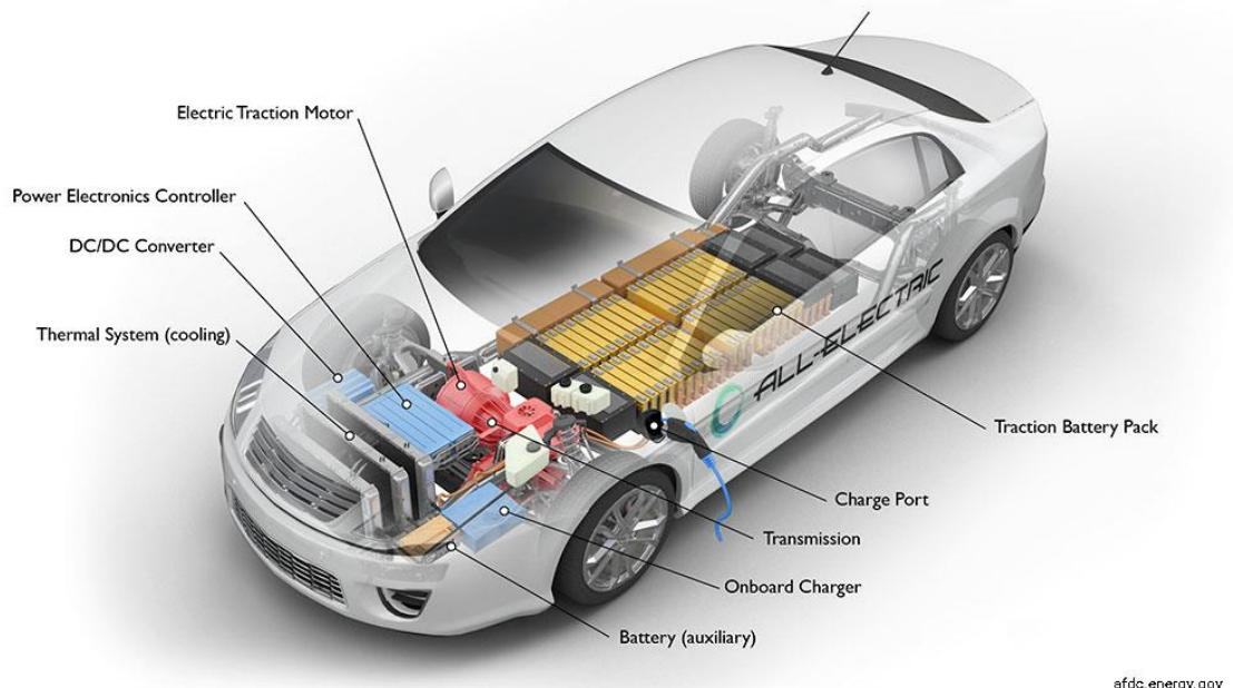
Slika 3. Konfiguracija baterijskog električnog vozila
