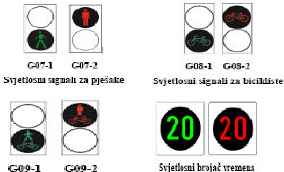
Slika 17. Oblici i boje svjetlosnih uređaja kojima se upravlja prometom pješaka i biciklista
