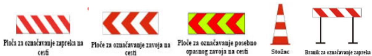
Slika 23. Oprema, znakovi i oznake za označavanje zavoja, radova, zapreka i oštećenja
