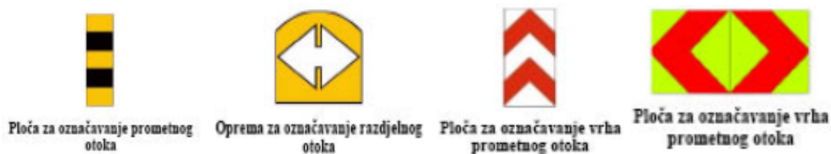
Slika 22. Prikaz opreme za označavanje vrhova prometnih otoka
