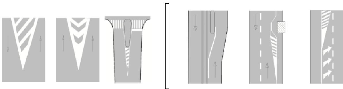
Slika 13. Prikaz primjera polja (lijevo) i crta (desno) za usmjerenje prometa
