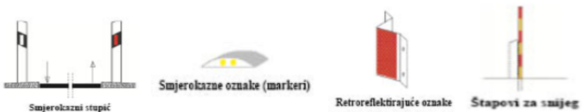
Slika 21. Prikaz prometne opreme za označavanje ruba kolnika
