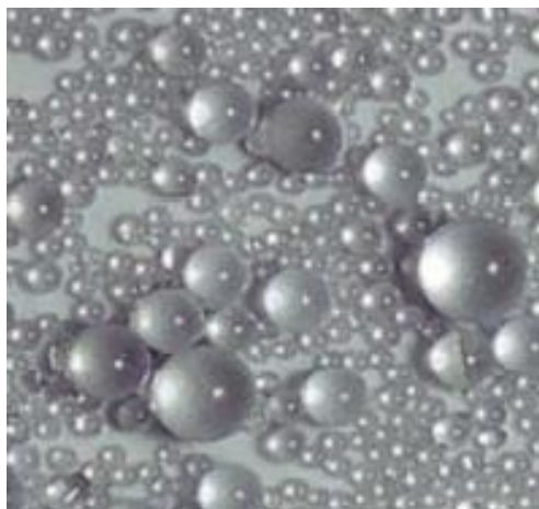
Slika 25. Različite granulacije staklenih kuglica
