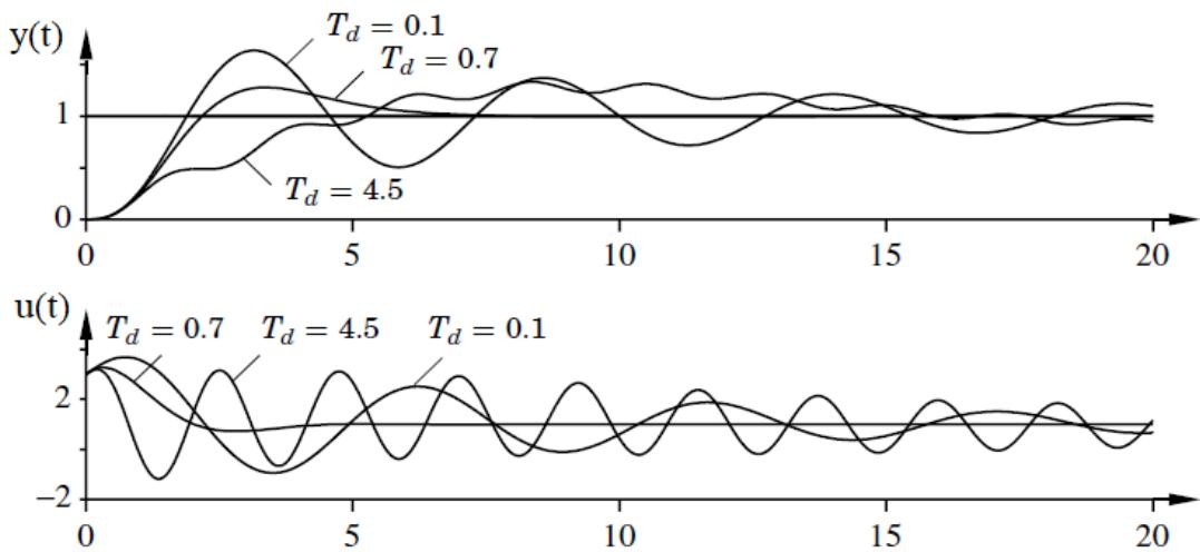
**Grafikon 3.** Primjer simulacije zatvorenog sustava sa proporcionalnim, integralnim i derivacijskim regulatorom i objekta regulacije prijenosne funkcije  $G(s) = 1/(s+1)^3$ ,  $K = K_p = 3$ ,  $T_i = 2$  [15]
