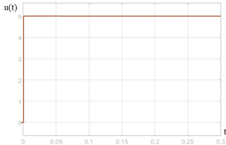
**Grafikon 6.** Odskočna (step) funkcija na ulazu aktuatora (puni otklon 5°)
