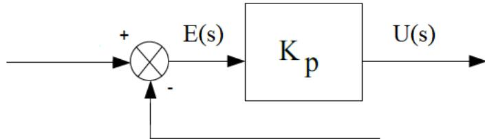
Slika 14. Blok shema proporcionalnog (P) regulatora [14]
