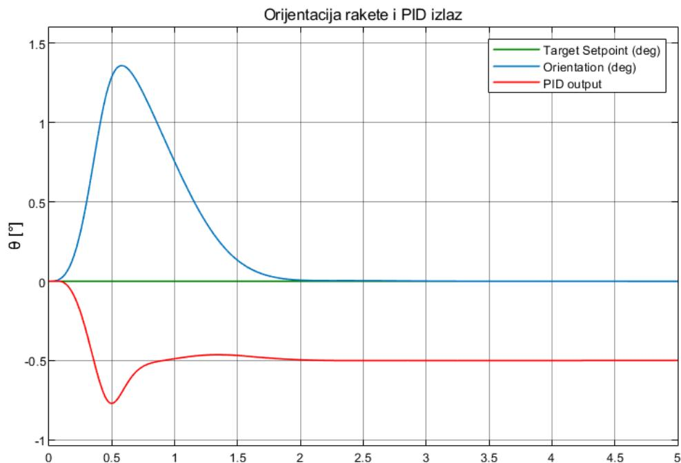
Grafikon 9. Promjena orijentacije raketne nosače  $\theta$  u odnosu na PID izlaz,  $\theta = 0^\circ$ , (Estes F15)
