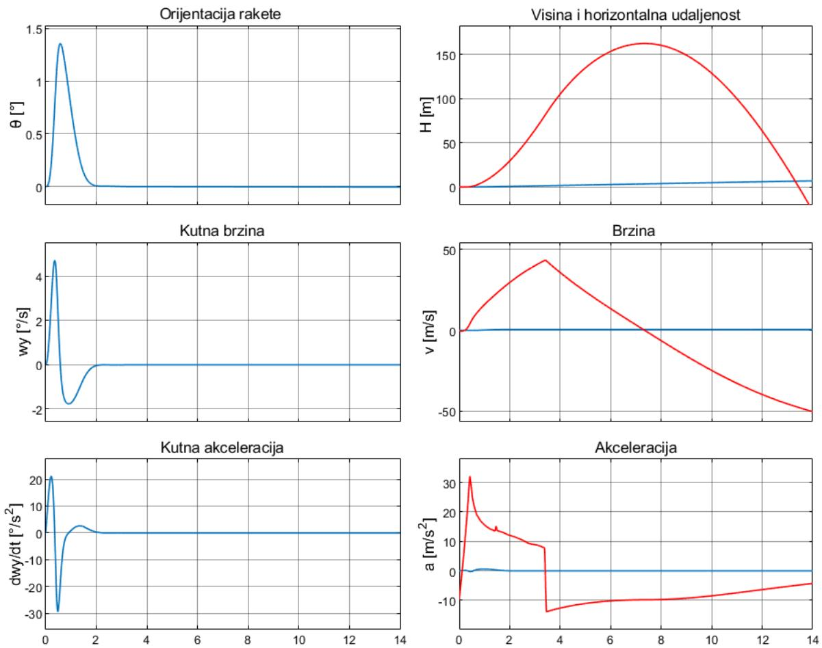
**Grafikon 16.** Prikaz stanja 3DOF elementa nakon lansiranja uz utjecaj otpora zraka  $\theta = 0^\circ$ ,
