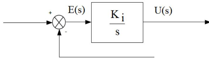
Slika 15. Blok shema integralnog (I) regulatora [14]
