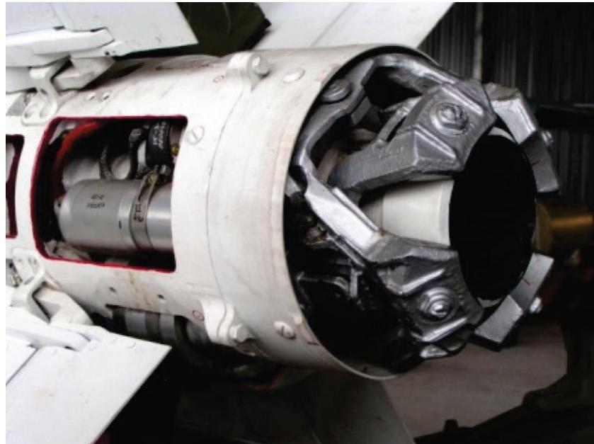
Slika 11. Segmentni kupolasti deflektor (R73 zrak-zrak raketa) [10]
