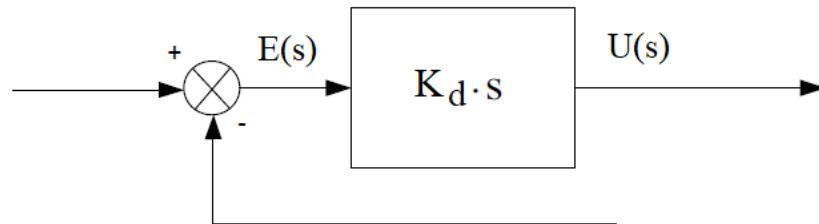
Slika 16. Blok shema derivacijskog (D) regulatora [14]
