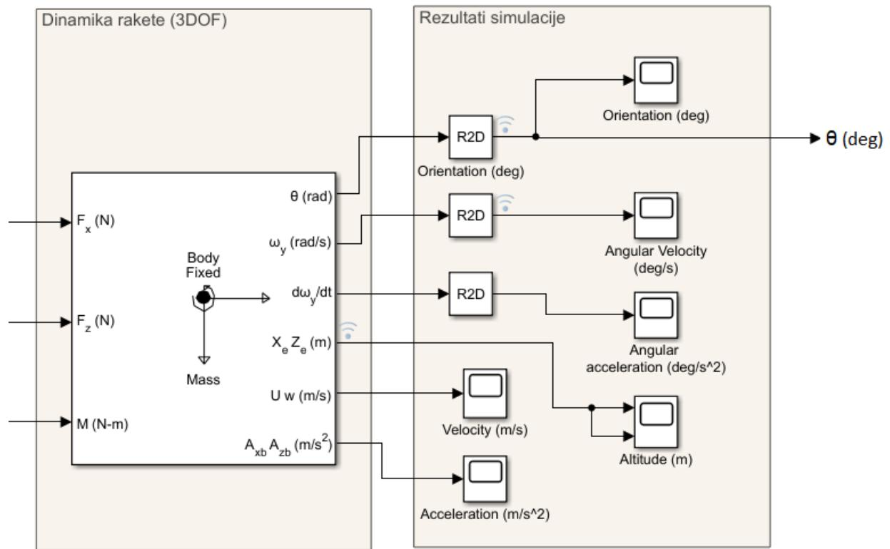
Slika 28. Dinamika rakete sa sekcijom za rezultate simulacije
