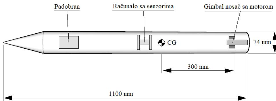
Slika 20. Dimenzije modela rakete sa pripadajućim elementima
