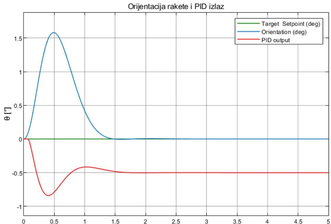
**Grafikon 13.** Promjena orientacije rakete  $\theta$  u odnosu na PID izlaz (Step),  $\theta = 0^\circ$
