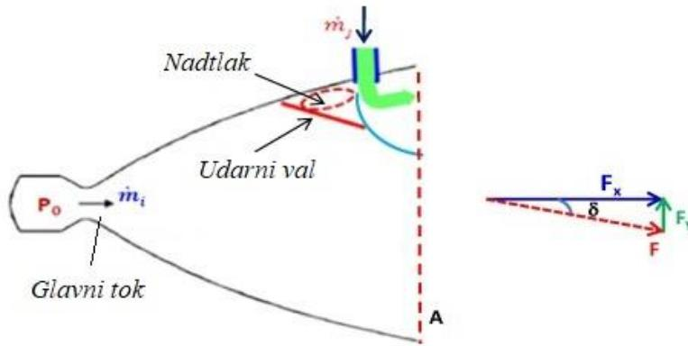
Slika 7. Sustav otklona vektora potiska pomoću fluida
