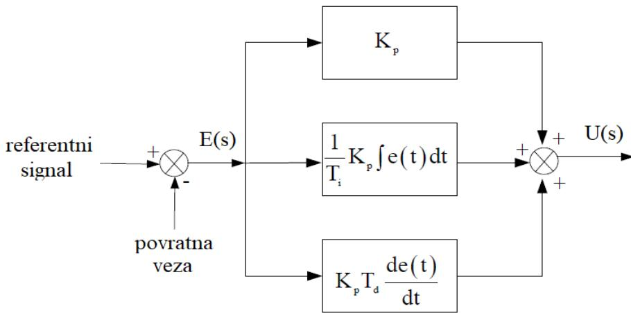
Slika 17. Blok shema PID regulatora [14]
