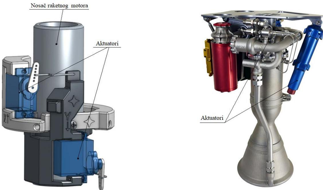
Slika 25. Gimbal nosač raketnog motora modela rakete i koncept stvarne izvedbe [20],[21]
