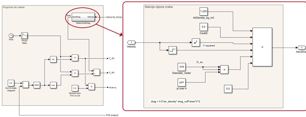
Slika 33. Prikaz pogonskog dijela sa uključenim otporom zraka
