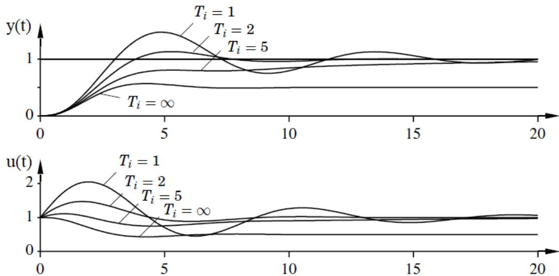
**Grafikon 2.** Primjer simulacije zatvorenog sustava sa proporcionalnim i integralnim regulatorom i objekta regulacije prijenosne funkcije  $G(s) = 1/(s+1)^3$ ,  $K = K_p = 1$  [15]
