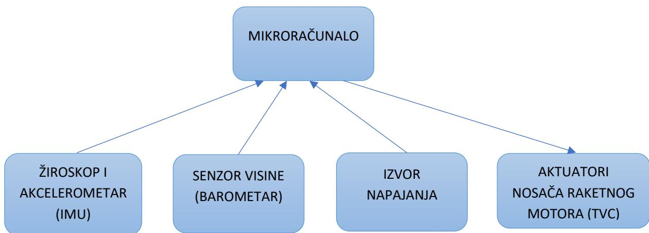
Slika 22. Osnovni koncept upravljanja modelom rakete
