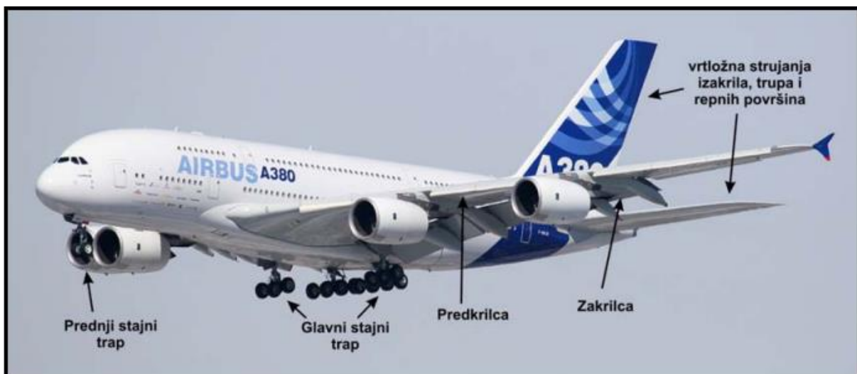
Slika 4. Izvori strukturne buke zrakoplova, IZVOR: [5]
