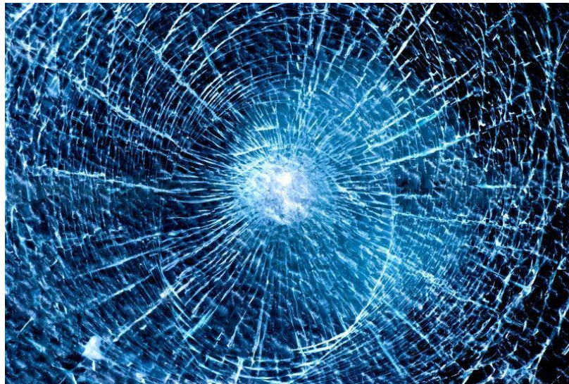
Slika 2. Lom kaljenog vjetrobranskog stakla uslijed vanjskog udara
