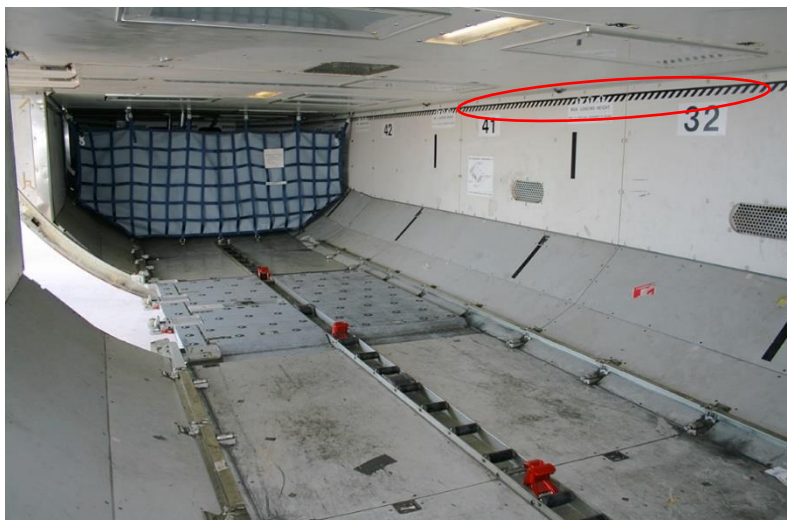
Slika 3.14: Oznaka maksimalne visine popunjenosti teretnog prostora Izvor: https://www.jetphotos.com/photo/5918720 , preuzeto: 28.4.2021.
