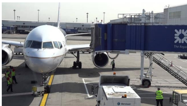
Slika 3.6: Prikaz primicanja zračnog mosta do zrakoplova Izvor: https://www.youtube.com/watch?v=42GxmgzxsMI , preuzeto: 5.7.2020.
