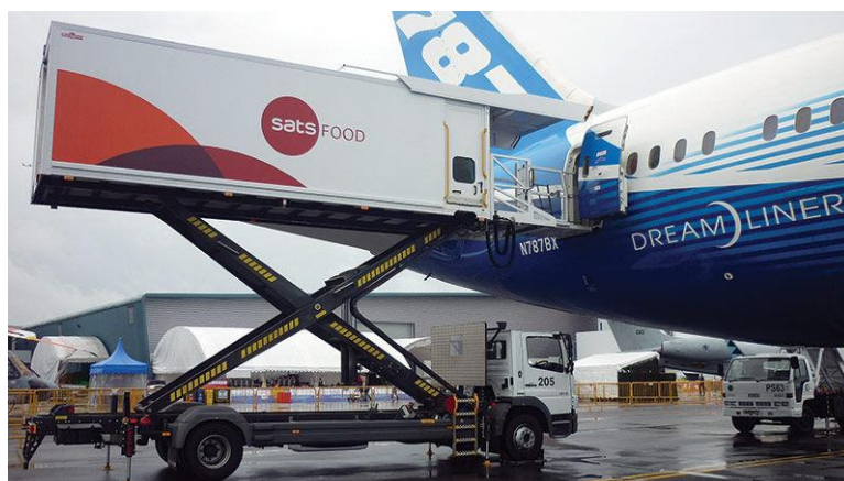
Slika 3.9: Prikaz opskrbe zrakoplova hranom i pićem dostavnim vozilom Izvor: https://www.aeroexpo.online/prod/mallaghan/product-168807-12291.html , preuzeto: 7.7.2020.
