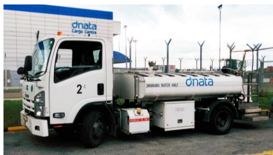
Slika 3.13: Cisterna s pitkom vodom
