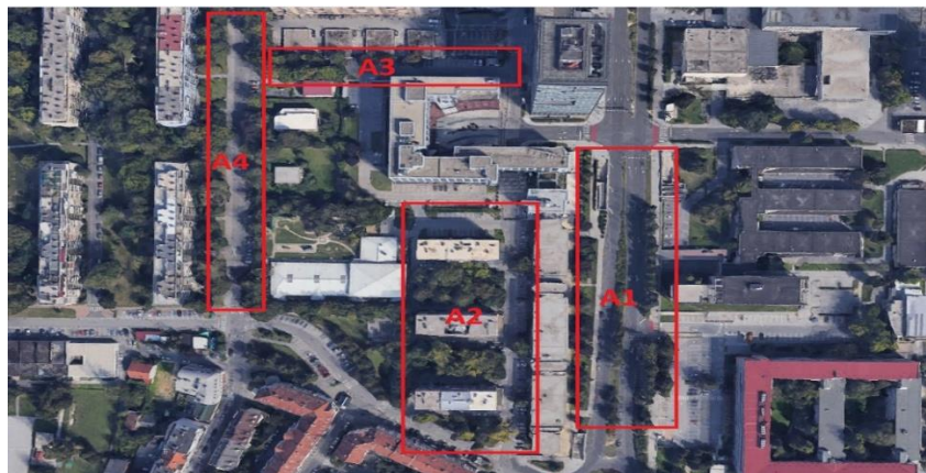
Slika 6. Funkcionalna podjela analizirane parkirališne površine po zonama
