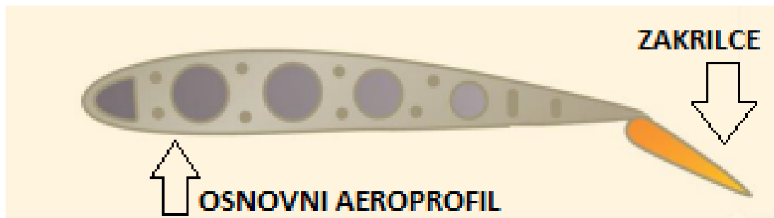
Slika 18. Podijeljeno zakrilce s translacijom
