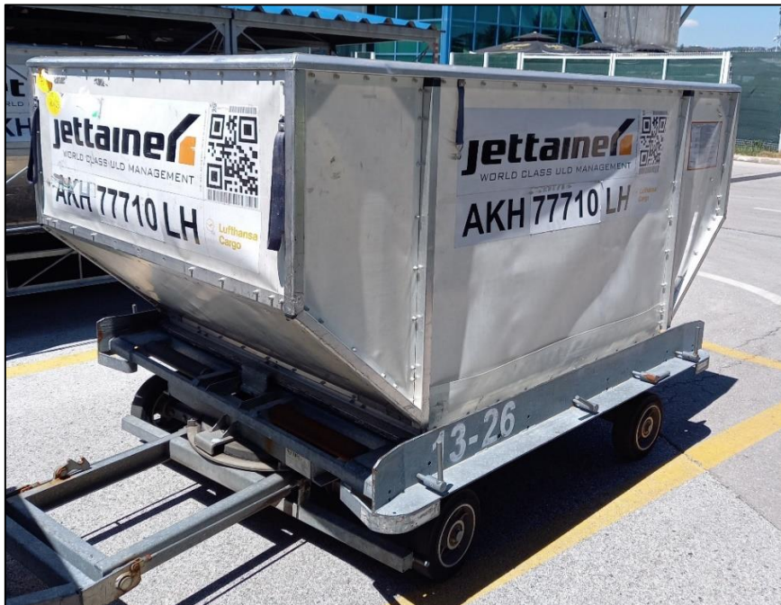
Slika 3: Prikaz ULD kontejnera tipa AKH
