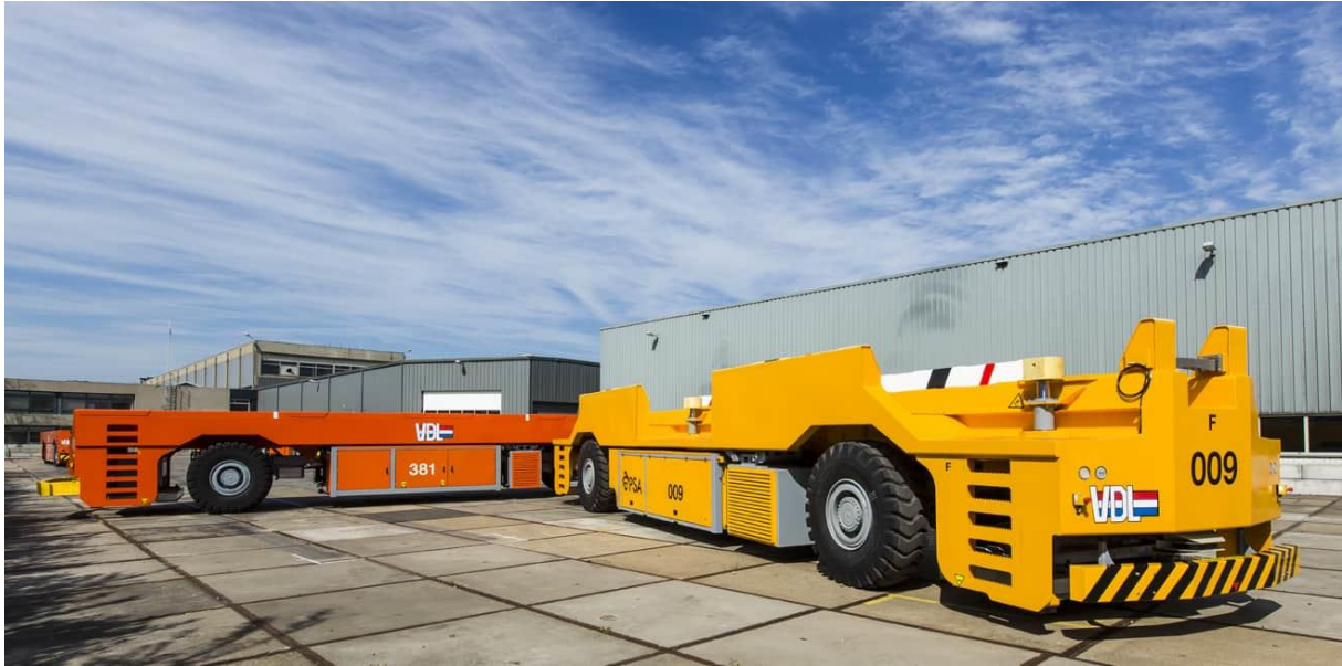
Slika 9: AGV - automatski vođeno vozilo
