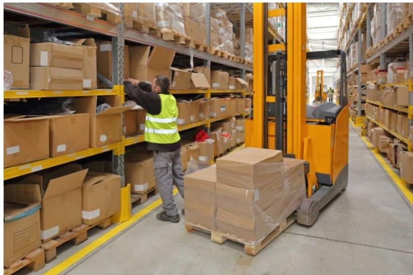
Slika 9. Princip komisioniranja „čovjek robi“
