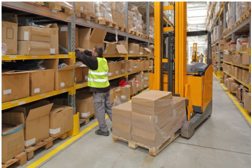
Slika 9. Princip komisioniranja „čovjek robi“
