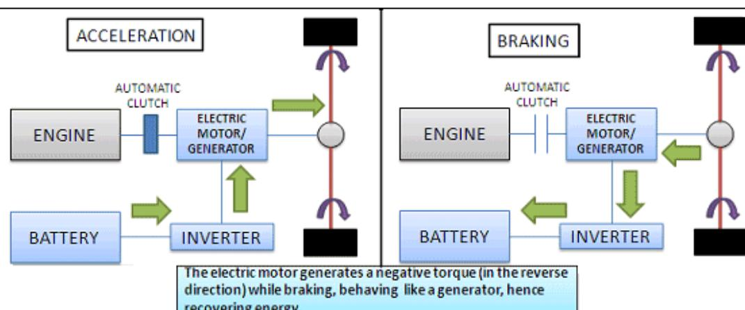
Slika 6. Blok dijagram prikaz principa rada regenerativnog kočenja [10]
