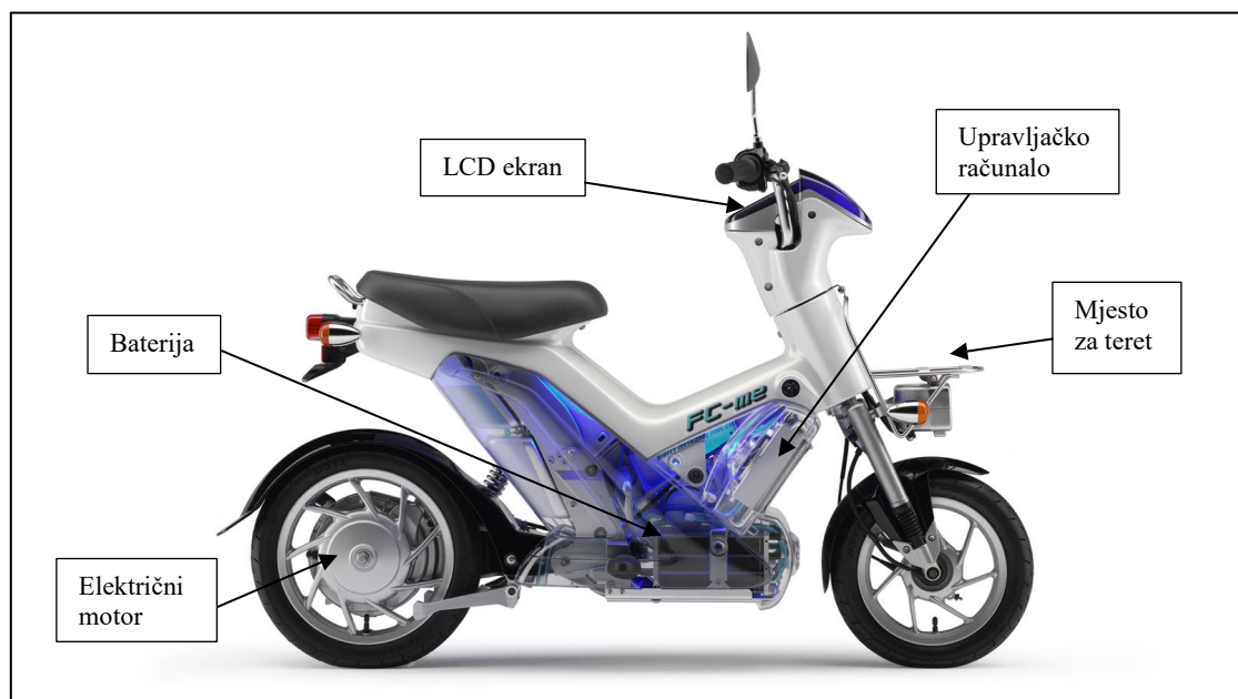
Slika 1. Shema električnog mopeda [1]
