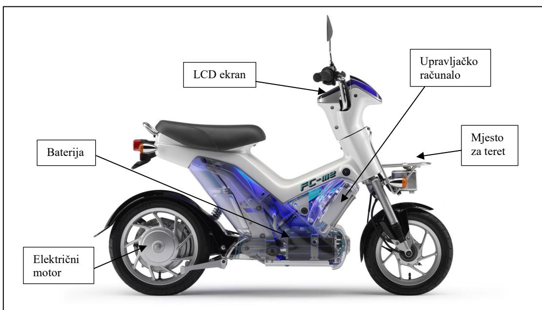
Slika 1. Shema električnog mopeda [1]
