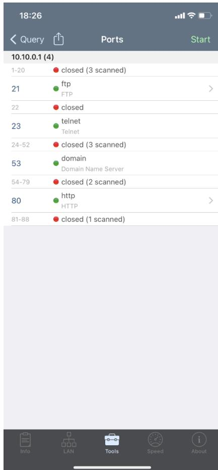
Slika 27. Opcija skeniranja portova alata *Network Analyzer Pro*
