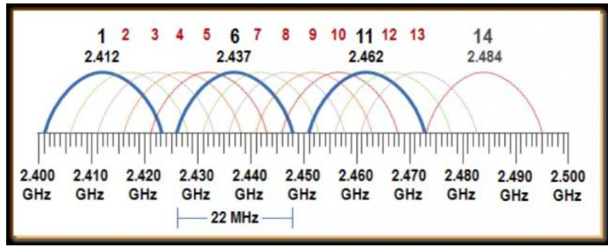
Slika 3. Plan iskoristivosti kanala frekvencijskog pojasa od 2.4 GHz, [27]
