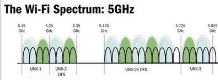
Slika 4. Plan iskoristivosti kanala frekvencijskog pojasa od 5 GHz, [29]
