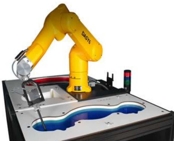
Slika 4. Testiranje zračenja na fantomskoj glavi, [30]
