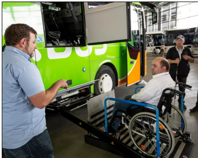
Slika 13. Podizanje osobe u kolicima u autobus pomoću dizala. Izvor: [25]
