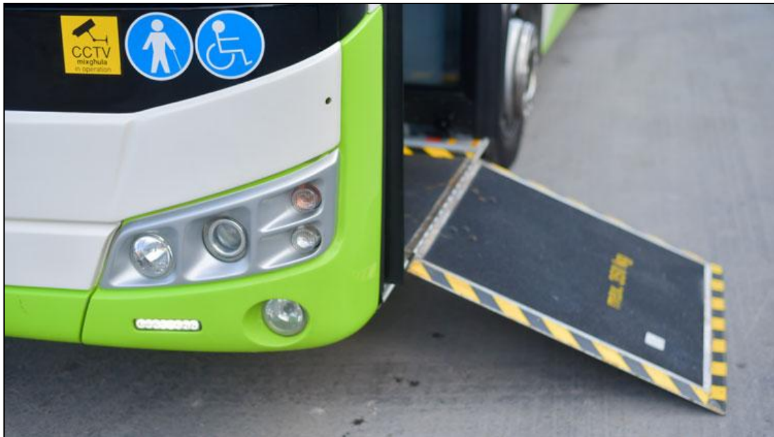
Slika 15. Rampa za autobuse
