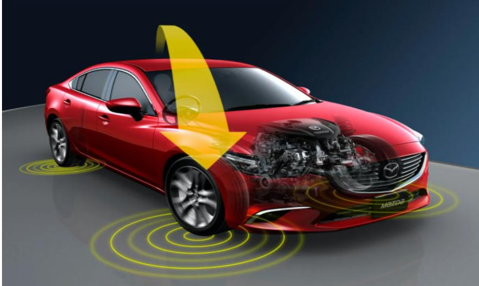
Slika 21. Mazda G Vectoring sustav [39]
